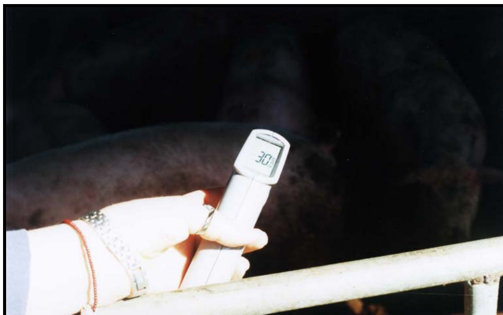
Figura 6 - Vista do termômetro infravermelho utilizado na medição da temperatura de superfície (camas e piso de concreto) e temperatura da pele dos animais.
