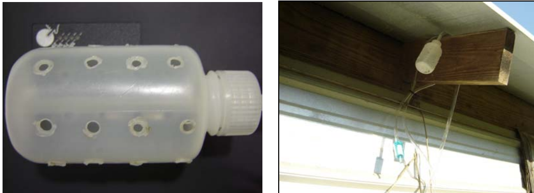
FIGURA 9. Detalhe da Garrafa Perfurada instalada na extremidade do tubo de ar utilizada para minimizar a interferência do vento na Medição de Pressão Estática.
