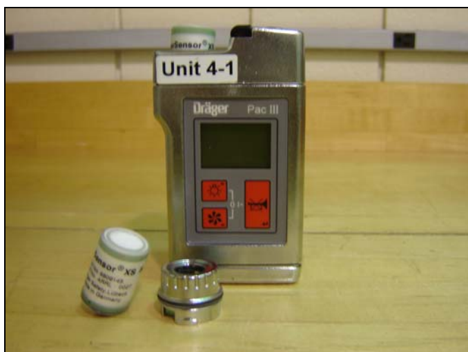
FIGURA 13. Detalhe das Novas Células Sensoras de amônia Instaladas nos Instrumentos Dräger PAC III da unidade portátil de monitoramento avaliada.
