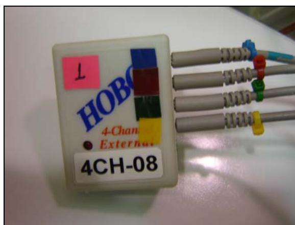
FIGURA 15. Sistema de Aquisição de Dados HOBO de quatro canais utilizado em cada Unidade Portátil de Monitoramento, destinado a armazenar dados de pressão estática, temperatura e estado ligado/desligado do temporizador e dióxido de carbono.
