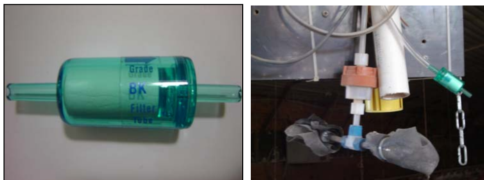
FIGURA 16. Filtro Instalado na Extremidade dos tubos de coleta de amostra de ar para evitar a interferência de poeira na leitura.
