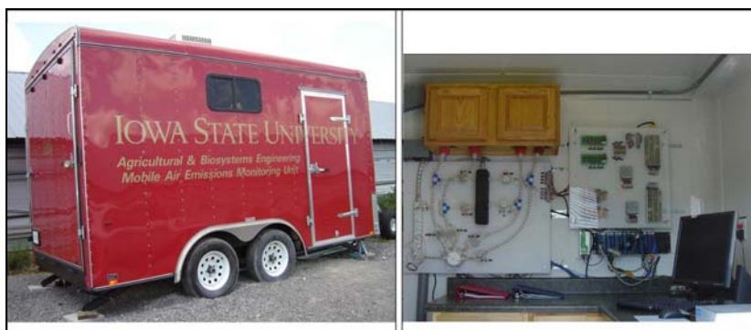
FIGURA 1. UMMEA: Vista de fora do trailer e interior do trailer com computador e tubulações de gases.
