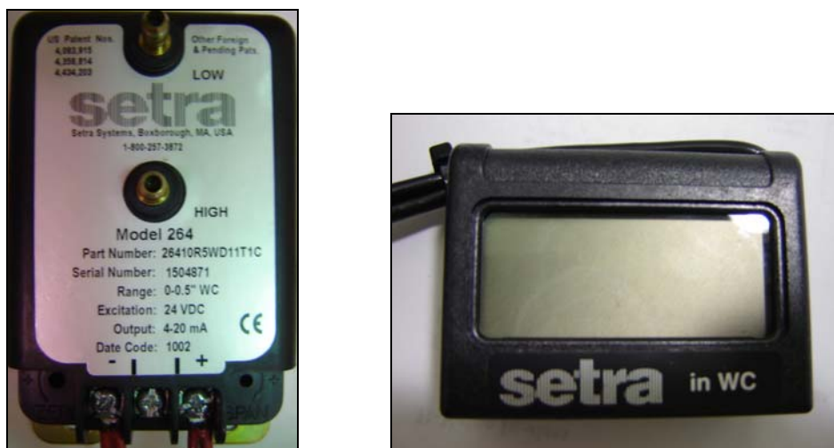
FIGURA 8 . Instrumento Setra Modelo 264 utilizado para medição da pressão estática nos galpões e Visor.
