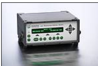
FIGURA 2. INNOVA: Monitor Fotoacústico de Gases utilizado na unidade de referência UMMEA para medição da concentração de amônia.
