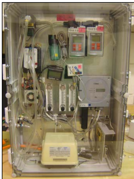
FIGURA 3. UPM: Unidade Portátil de Monitoramento avaliada.
