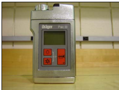
FIGURA 11. Sensor de Amônia Dräger PAC III, utilizado na Unidade Portátil de Monitoramento, avaliada na pesquisa.
