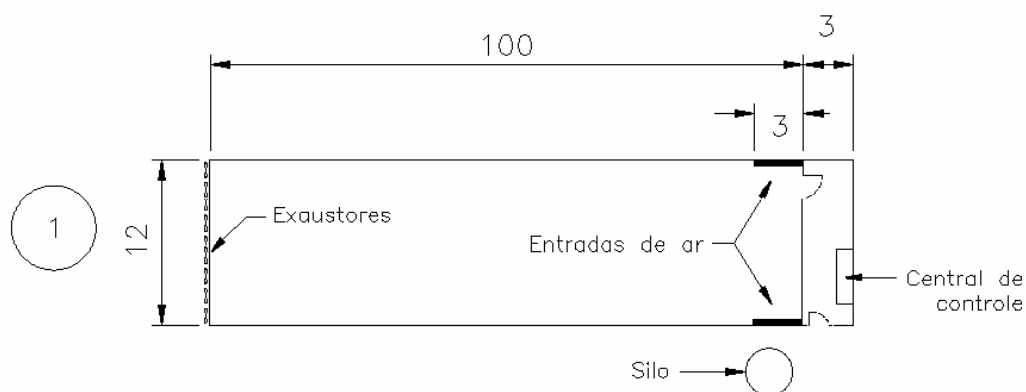
FIGURA 2. Croqui - detalhe das entradas de ar e da posição dos exaustores na instalação semi-climatizada com ventilação por pressão negativa.
