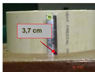
FIGURA 7 – Esquema dos gasômetros: vista externa dos gasômetros (a) e régua graduada no gasômetro para a leitura (b).
