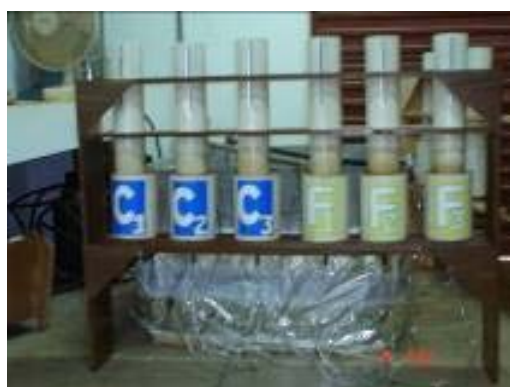
FIGURA 7 – Esquema dos gasômetros: vista externa dos gasômetros (a) e régua graduada no gasômetro para a leitura (b).
