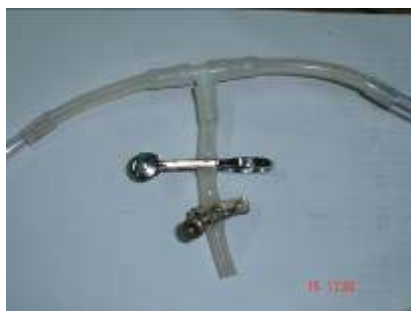
FIGURA 8 – Conexão e grampo metálico, adaptados nos pontos de amostragem do biogás na mangueira de silicone.
