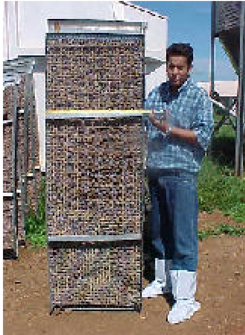
Figura 7– Vista frontal do painel de argila expandida.
